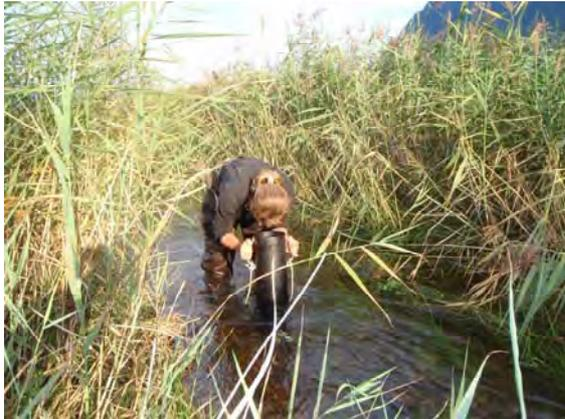
Abb. 15: Aufnahme der Korngrößen mit Hilfe des Guckrohrs.
