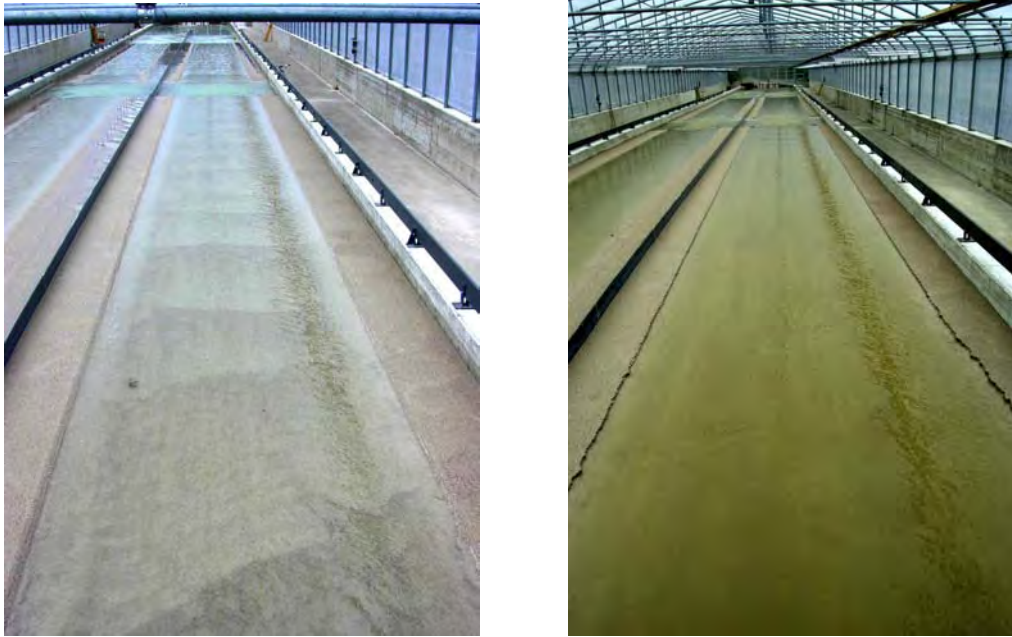
Abb. 8.11: Aufnahmen beim Versuch A1: links) 5 Stunden (1 Naturtag) nach Versuchsbeginn; rechts) nach 27 Stunden (5 Naturtage), als die Gerinnebreite stabil wurde. (Aus VAO 2002).
