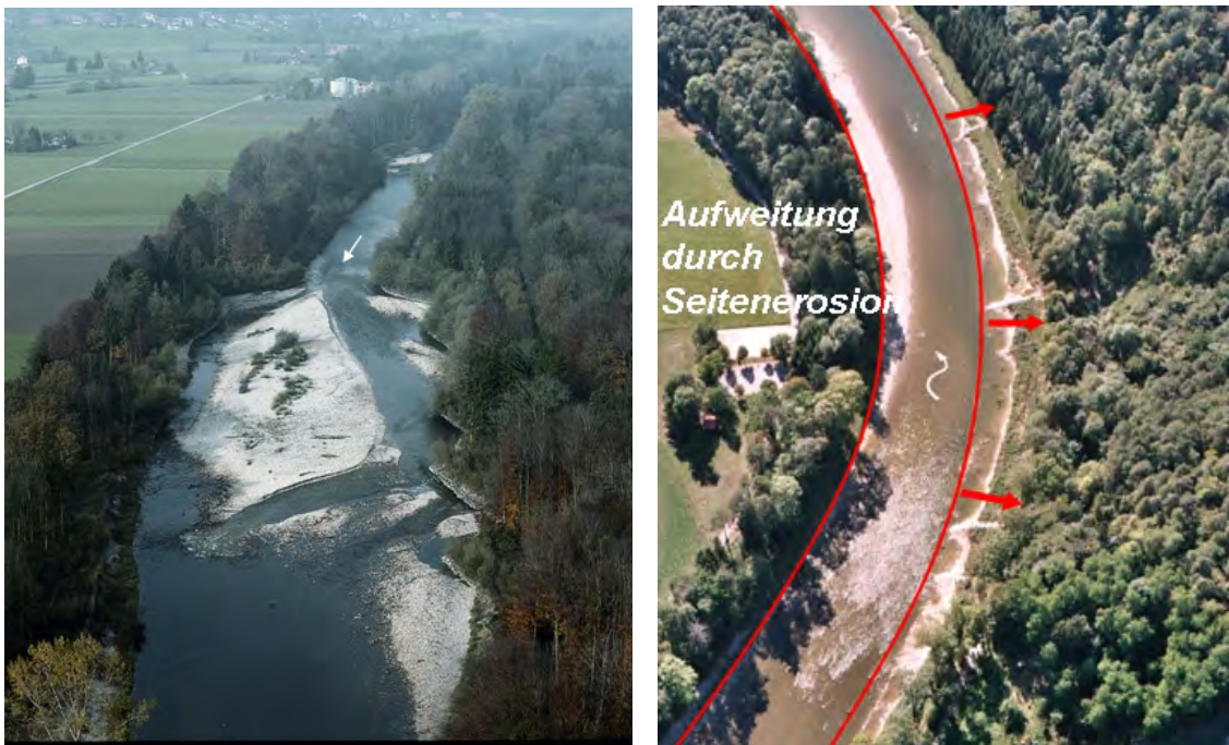
Abb. 2.6: Flussaufweitungen in der Natur: links) maschinelle Aufweitung an der Emme zwischen Aeflingen und Utzenstorf (Foto: Documenta Natura, 2004); rechts) Eigendynamische Aufweitung an der Thur in der Schiterberg-Kurve bei Alten (Foto: Chr. Herrmann, BHA-Team Frauenfeld, Sept. 2003).
