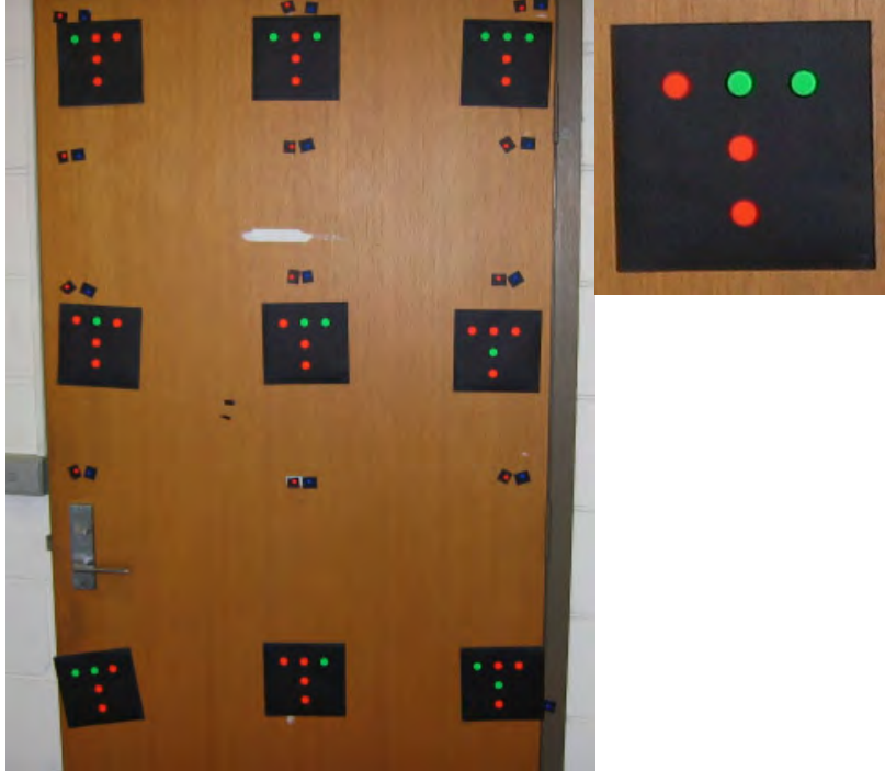
Abb. C.2: Referenzkörper zur automatischen Kalibrierung einer Digitalkamera mit dem Programm iWitness .
