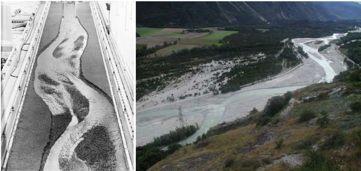
Abb. 5.3: Vergleich der in Modell (links) und in den Natur (rechts) aufgetretenen Morphologien bei grossen Breitenverhältnisse (Foto: Rhône bei Pfywald, EAWAG 2001)
