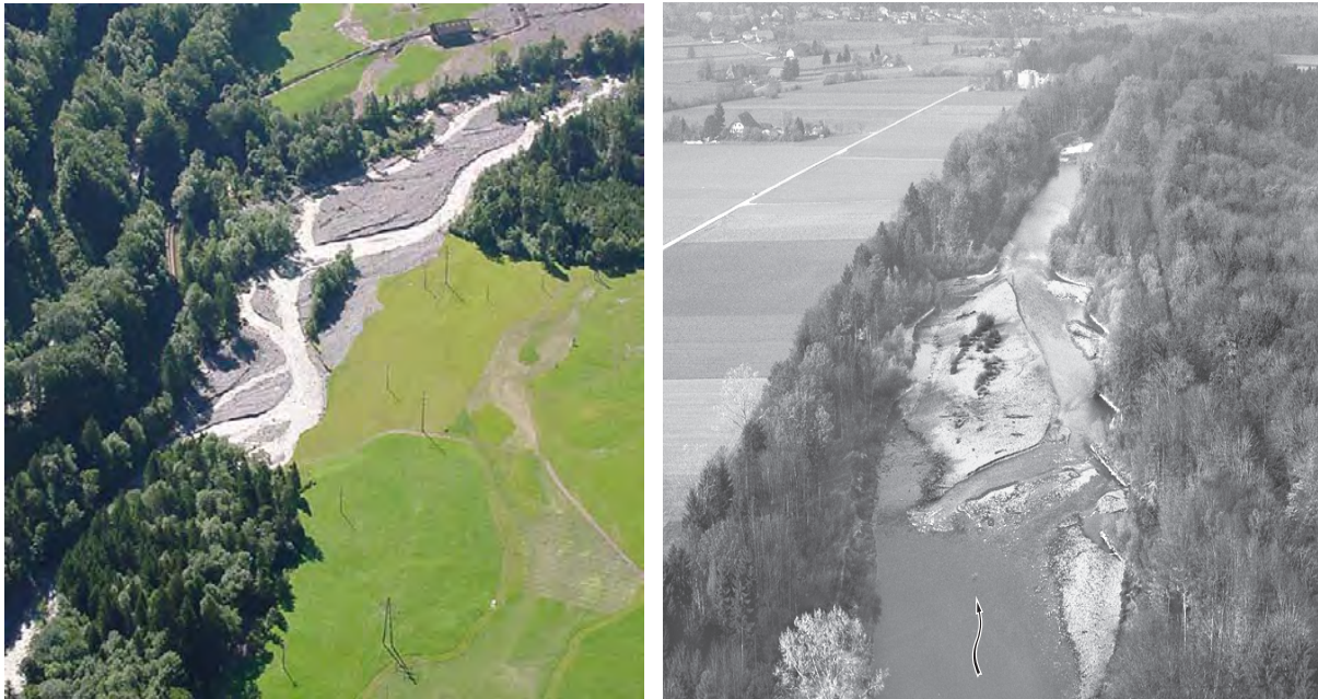
Abb. 7.7: Spontane Aufweitung an der Engelberger Aa (Fluss-Km 12.5-13.5, Foto: Niederer & Pozzi, 2005) (links) und an der Emme bei Aefligen (Foto: Doc. Natura,2004) (rechts). Die an der Engelberger Aa aufgetretenen Morphologie lassen sich gut mit denen aus der Serie 1 vergleichen, während die morphologische Strukturen an der Emme flach und gestreckt sind, wie die aus der Serie 2.
