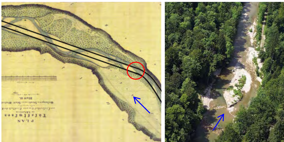
Abb. 1.1: Links: Abschnitt Töss im Leisental im Bereich der Aufweitunginsel wie sie sich 1843 zeigte. Schwarz eingetragen die Begradigung des Flussgerinnes gegen Ende des 19. Jahrhunderts. Rechts: Künstliche Mittelinsel bei der Aufweitung Mittlere Aue wie sie sich seit 2001 zeigt. Fließrichtung gemäss Pfeilen. (Abbildungen verändert nach Arnold, 2009)
