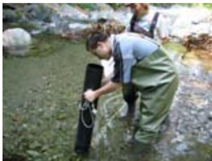
Ein 1,5 m langer Messstab wurde in Fließrichtung über die zu analysierende Deckschicht gelegt. Mit einem Schauglas konnte dann die mittlere Achse der Steine mit einem Durchmesser  $> 1$  cm unter dem Messstab bestimmt werden (Abb. 25). Die vermessenen Steine wurden in Durchmesserklassen eingeteilt und protokolliert.
