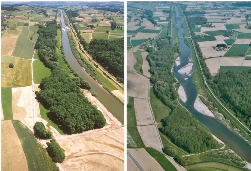
Abbildung 4.8: Die Thur bei Niederneunforn. Links: kanalisierte Thur im Juni 2001, Rechts: revitalisierte Thur mit alternierenden Kiesbänken (Mai 2004). (C. Herrmann, BHAtteam, Frauenfeld).
