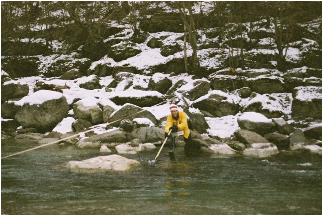
Abbildung 26: Messen der Fliessgeschwindigkeit bei der Aufnahme eines Querprofils
