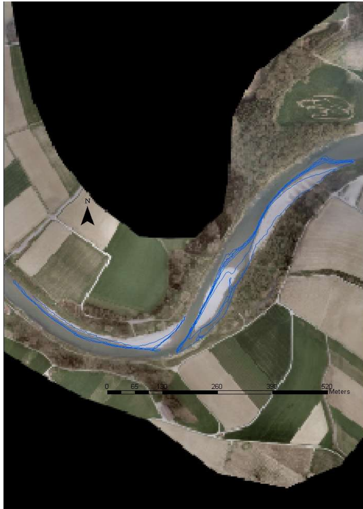
Abbildung 12: Luftbild der Aufweitung bei Güttinghausen mit GPS Aufnahmen der Uferlinien bei verschiedenen Wasserständen. Quelle: Luftbilder TG: mit Bewilligung des Amtes für Geoinformation, Frauenfeld; Luftbilder ZH, mit Bewilligung AWEL, Zürich.
