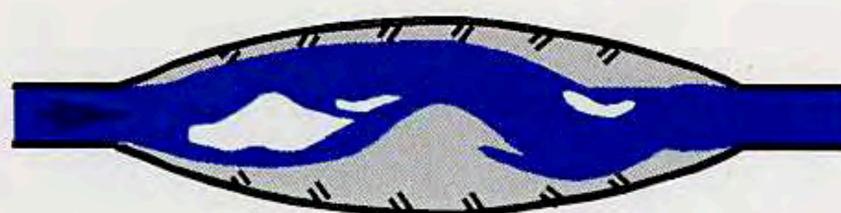
Beidseitige Aufweitung des Gerinnes mit Uferbefestigung
