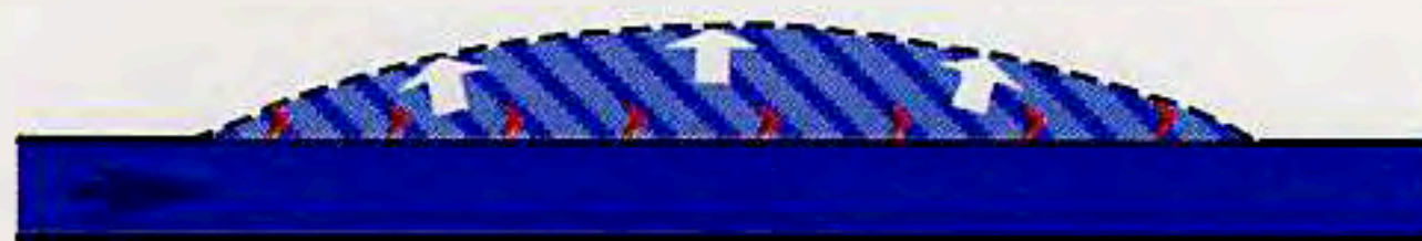
Einseitige Entfernung der Uferbefestigung und Tolerierung von Seitenerosion
