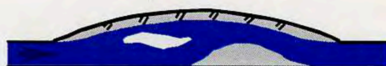
Einseitige Aufweitung des Gerinnes mit Uferbefestigung
