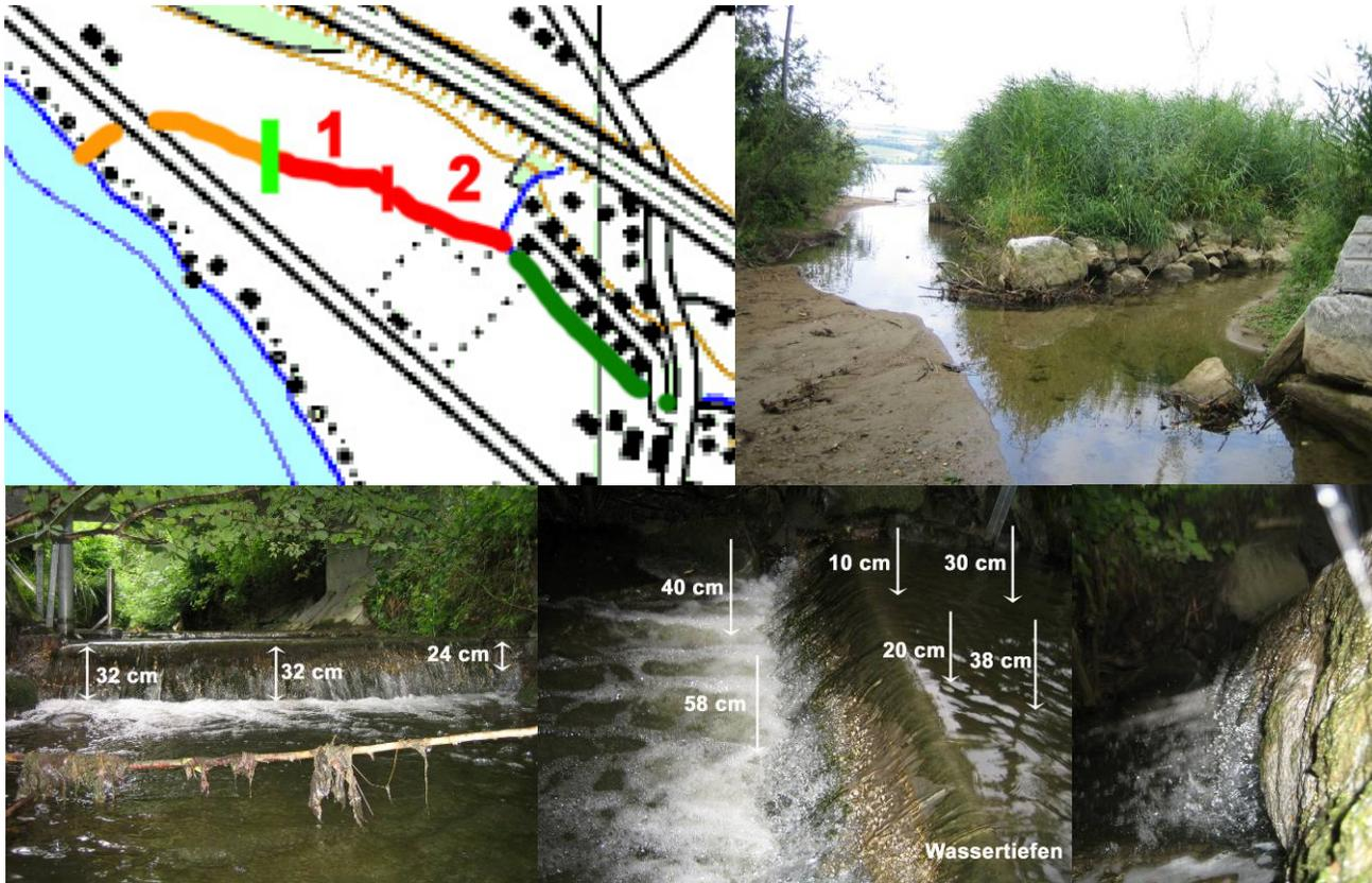
Abbildung 54: Rotbach mit den befisheten Strecken (oben links), Mündung (oben rechts) und die Schwelle (untere Reihe).
