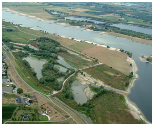
Figure 7.21 (photo de gauche) : Chenal secondaire nouvellement créé sur le Waal à Opijnen, Pays-Bas, juin 1997 (Photo : T. Buijse, RiZA, Pays-Bas).
