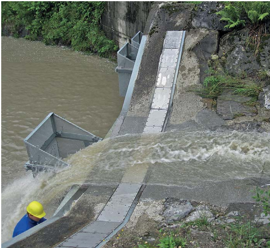
Bild 3. Geophon zur direkten Messung des Geschiebevolumens im Erlenbach (Foto: WSL).
