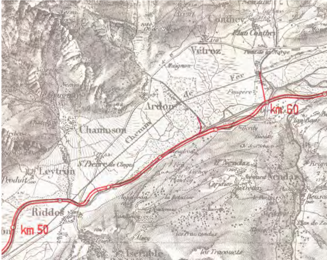
Abbildung 27: Ausschnitt aus der Dufour-Karte von 1850. Darüber ist der heutige kanalisierte Rhoneverlauf zwischen Kilometer 50 und 60 eingezeichnet (aus Département fédéral de l'intérieur, 1964, La correction du Rhône en amont du lac Léman , Publication du Service fédéral des routes et des digues, Bern).
