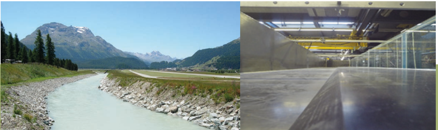
Fig. 2: Le site de la Flaz (GR) à analyser (gauche) et le modèle physique correspondant (droite) pour l'analyse du transport des sédiments fins. Le tronçon nouvellement aménagé de la Flaz à Samedan en 2006 sert de modèle pour les projets pilotes. L'expérience destinée à analyser le transport de sédiments fins est menée dans un canal d'écoulement artificiel et réduit au LCH-EPFL (photo de gauche Simon Schärer; photo de droite: Carmelo Juez).
