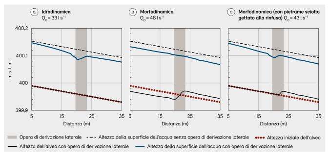
L'esondazione laterale risponde rapidamente alle variazioni di portata, a differenza del deposito locale e dell'accumulo. L'analisi con un idrogramma di piena breve mostra meno accumulo, meno deposito locale e meno esondazione laterale rispetto alla simulazione con un idrogramma di piena lungo. Durante la fase discendente dell'idrogramma di piena, il deposito locale e l'accumulo dei sedimenti vengono completamente erosi e viene ripristinato il livello dell'alveo precedente alla piena.
